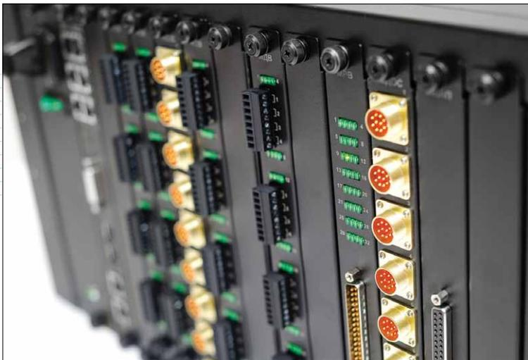
Рис. 3. КУДЛ (контроллер управления движением и логикой)
