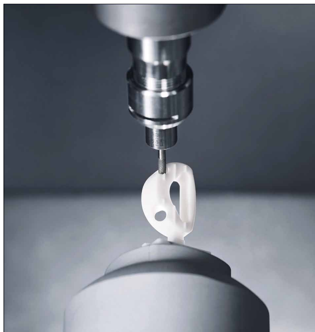
Ведется полная обработка ортопедического импланта из диоксида циркония
