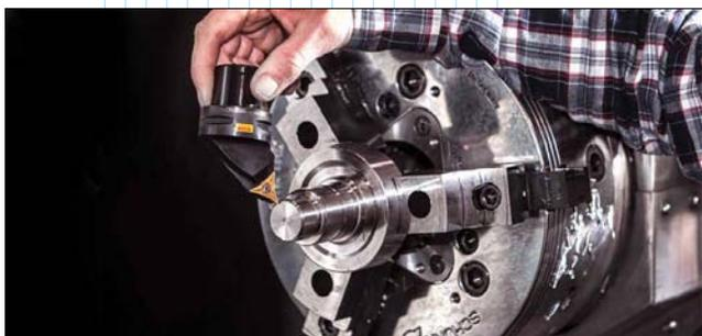
необходимо обработать уступ и исключить образование нежелательной длинной, изогнутой стружки, которая обычно формируется при малых углах. Концепция *PrimeTurning* решает эти проблемы, обеспечивая хороший доступ для обработки уступа при углах 25÷30 градусов, а также точное соблюдение допусков и превосходный контроль над стружкой.
