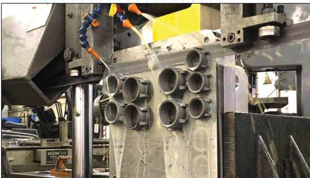
Напечатанные на 3D-принтере металлические детали передаются на механический участок для их удаления с монтажной плиты при помощи точной распиловки
