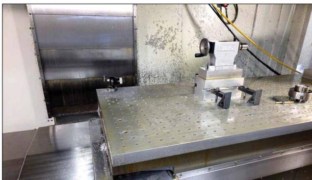
*Для обеспечения совместимости при работе на разном оборудовании в цехе Imperial давно используются одинаковые шаблоны крепежных отверстий. Когда к аддитивно изготавливаемой детали добавляют дополнительные элементы для её фиксации при дальнейшей обработке, это тоже делается в соответствии с шаблонами*
