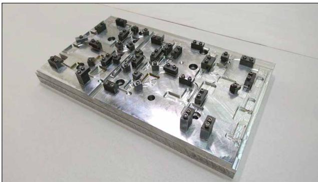
*Прежде это была плита с просверленными отверстиями для охлаждения. Переход на 3D-печать детали в виде плетеной структуры каналов охлаждения позволил устранить ненужный материал и уменьшить массу. Сама деталь запатентована разработчиком, но дополнительные элементы для её фиксации при дальнейшей механообработке разработала команда Imperial*
