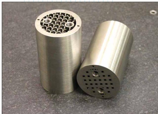
*Перепроектирование деталей с учетом возможностей аддитивного производства часто означает замену ненужных сплошных объемов на ячеистые структуры. В данном случае замена сплошной детали, в которой высверливались сквозные каналы, на 3D-печатную позволила уменьшить её массу почти вдвое*
