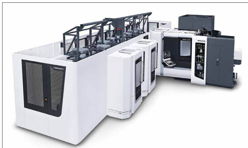
Компания DMG MORI продемонстрировала свои компетенции в области систем автоматизации на примере ГПС, объединяющей два горизонтальных обрабатывающих центра – NHX 5000 и DMC 60 H linear – и линейный накопитель паллет LPP 24
