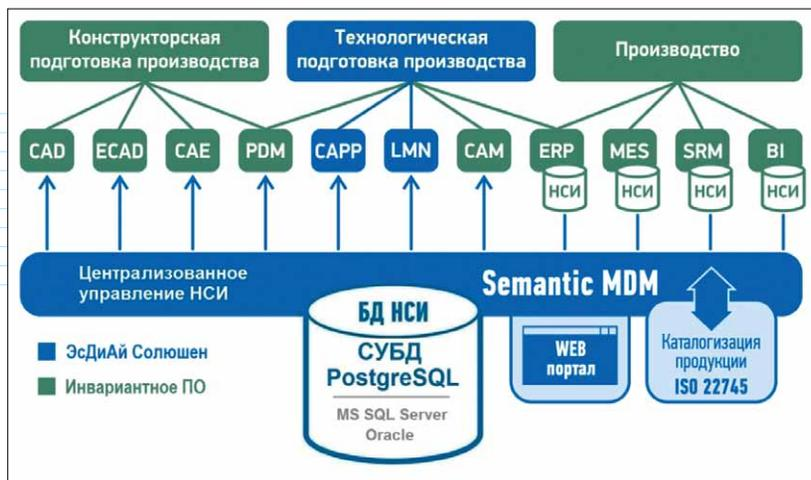
Рис. 15. Архитектура инженерного программного комплекса на платформе российской *MDM*-системы
