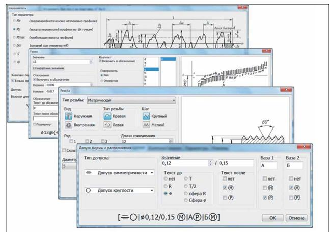
Рис. 10. Специализированные формы для редактирования технологических параметров
