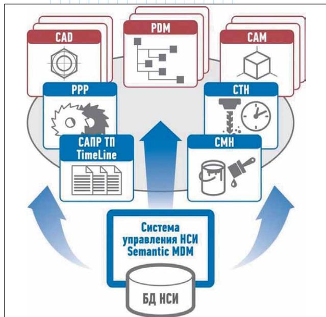
Рис. 14. Конструкторско-технологический программный комплекс на базе *Semantic MDM*
