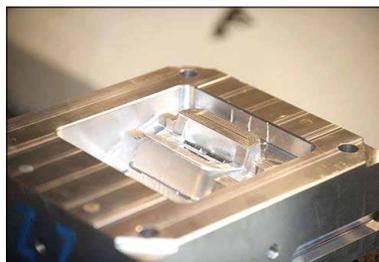
Выставление жестких допусков при формировании траектории инструмента и более качественная финишная обработка уменьшают количество дополнительных операций при изготовлении пресс-формы
