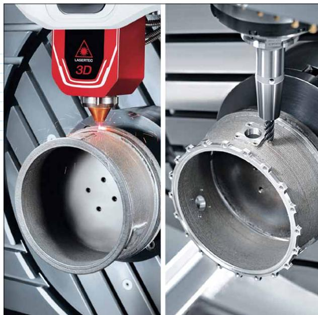
*Интеграция технологий, реализованная компанией DMG MORI: лазерная наплавка и 5-осевое фрезерование обеспечивают высокую чистоту и непревзойденную точность обработки*
