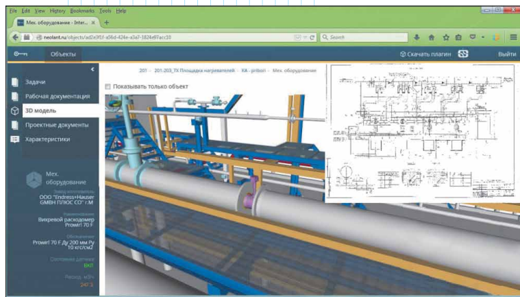
Рис. 2. Пример реализации доступа к данным (характеристики насоса) в среде НЕОСИНТЕЗ посредством 3D-модели и 2D-чертежа
