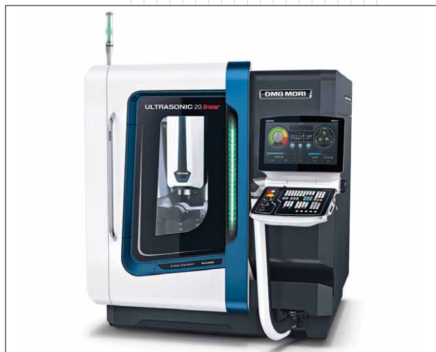
Мировая премьера: ULTRASONIC 20 linear второго поколения – компактный станок для 5-осевой обработки новых материалов, обеспечивающий высокоскоростное фрезерование
