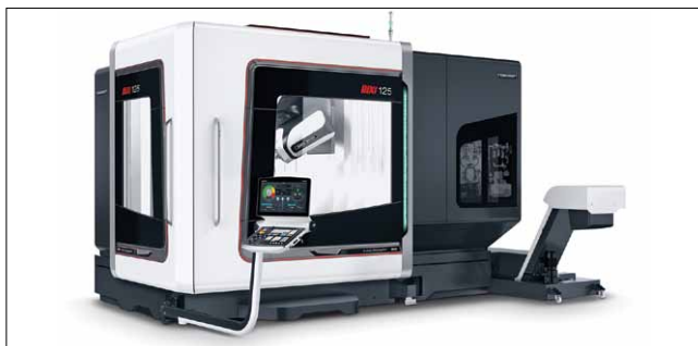
Мировая премьера: высокоточный обрабатывающий центр DIXI 125. Максимальная объемная точность < 15 мкм, точность позиционирования – до 3 мкм
